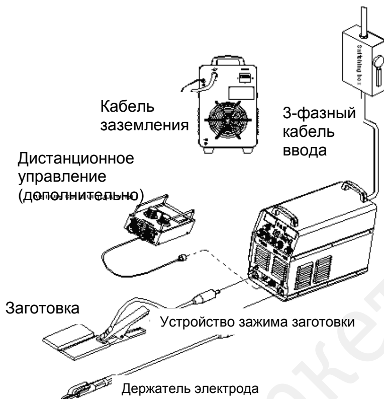
Рисунок 8.2.: Карта-схема установки при сварке ММА покрытым электродом
