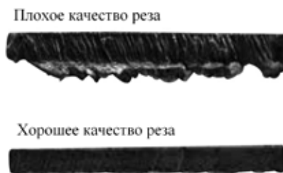
Рис. 7.3. Влияние силы тока и скорости реза.
