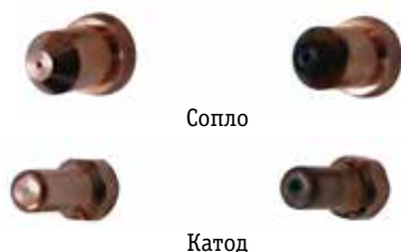
Рис. 7.6. Износ сопла и катода.
